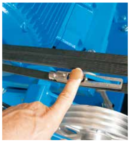
Optikrik-tester from Optibelt
